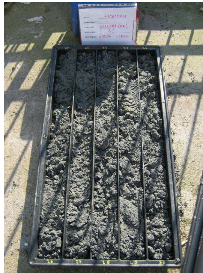
Foto n.8 Vista delle carote estratte dal Sondaggio S2 25 – 30 m
