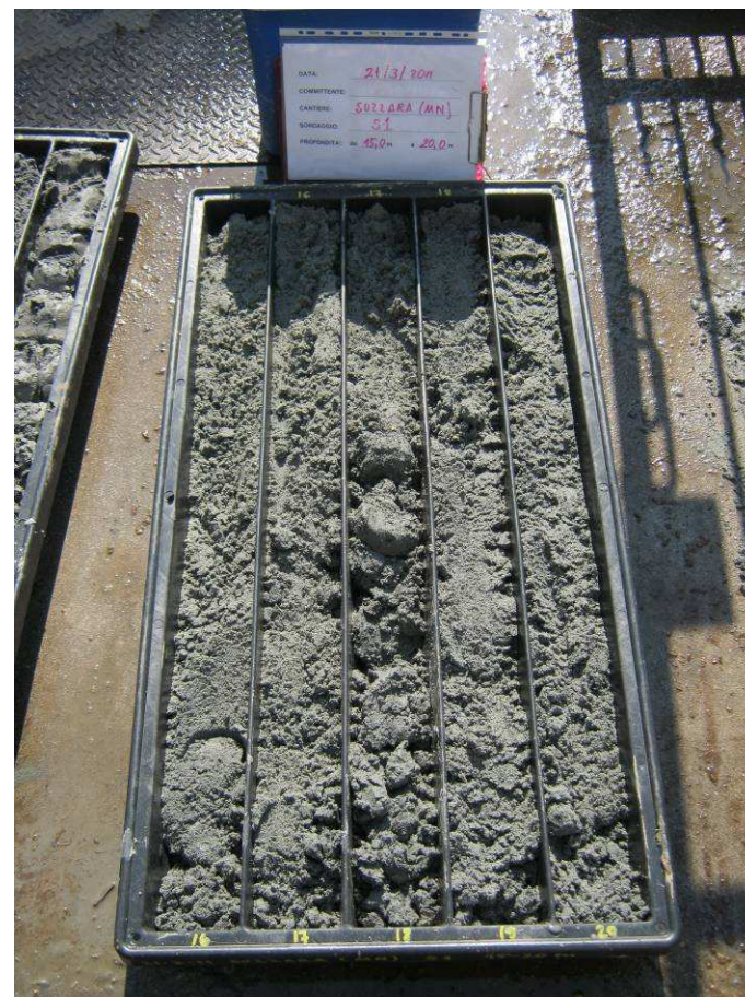
Foto n.6 Vista delle carote estratte dal Sondaggio S2 15 – 20 m ↑
