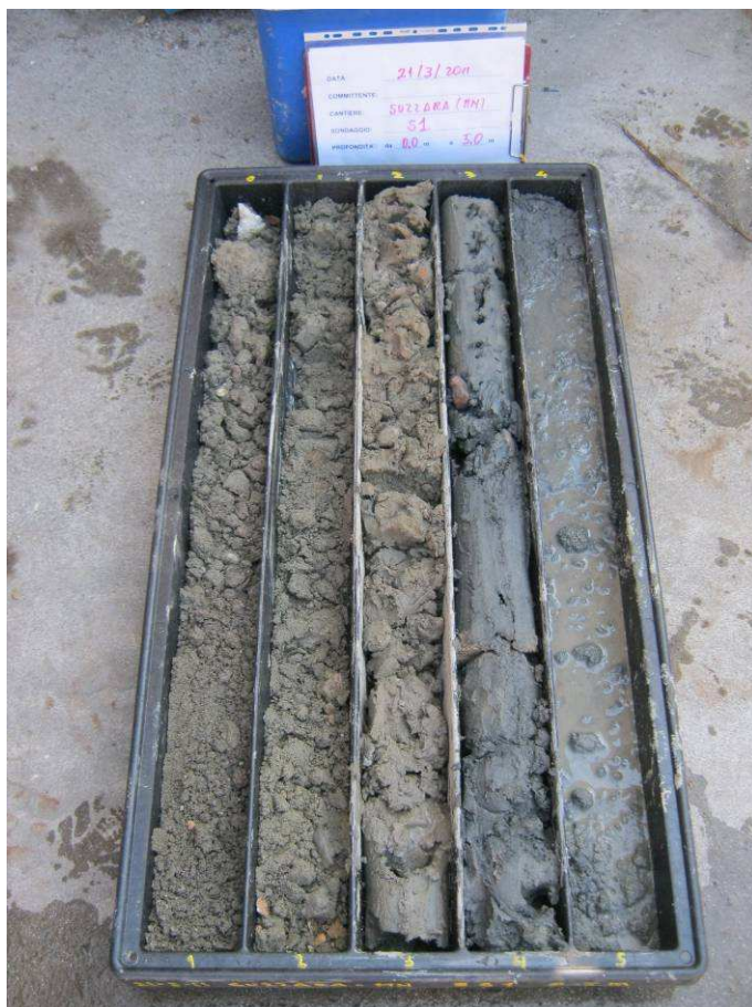
Foto n.3 Vista delle carote estratte dal Sondaggio S1 0 – 5 m
