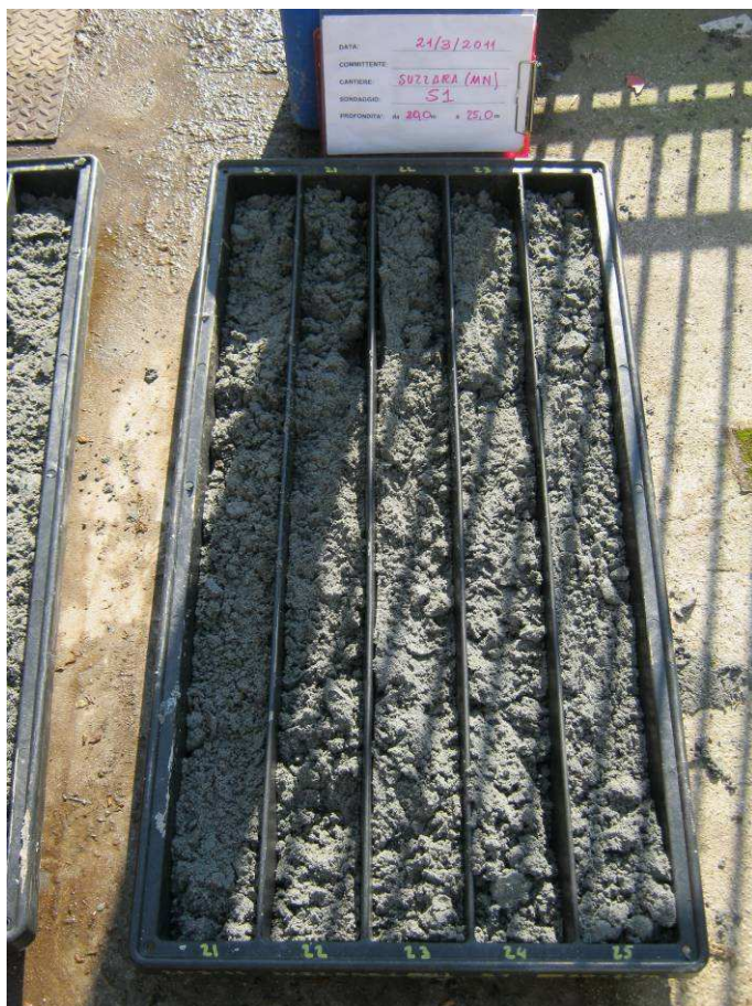
Foto n.7 Vista delle carote estratte dal Sondaggio S2 20 – 25 m
