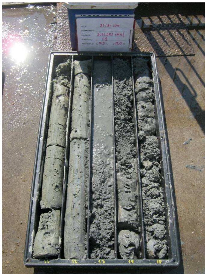
Foto n.5 Vista delle carote estratte dal Sondaggio S1 10 – 15 m ↑
